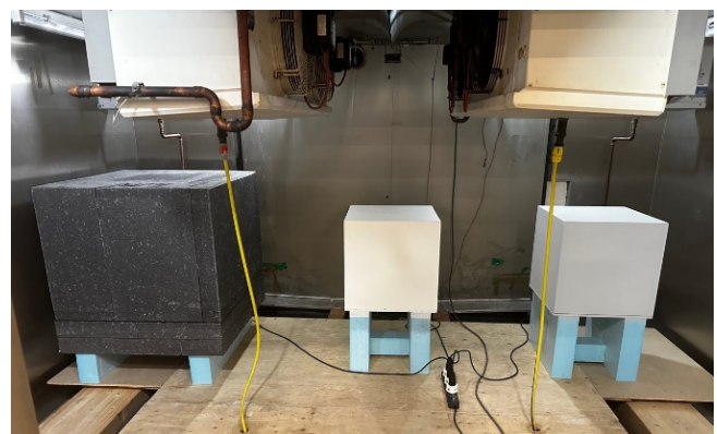
Bild 3.10: Ansicht der Klimakammer in der Versuchshalle des Instituts für Bauphysik. Die drei Versuchsaufbauten wurden simultan und unter gleichen Randbedingungen geprüft.
