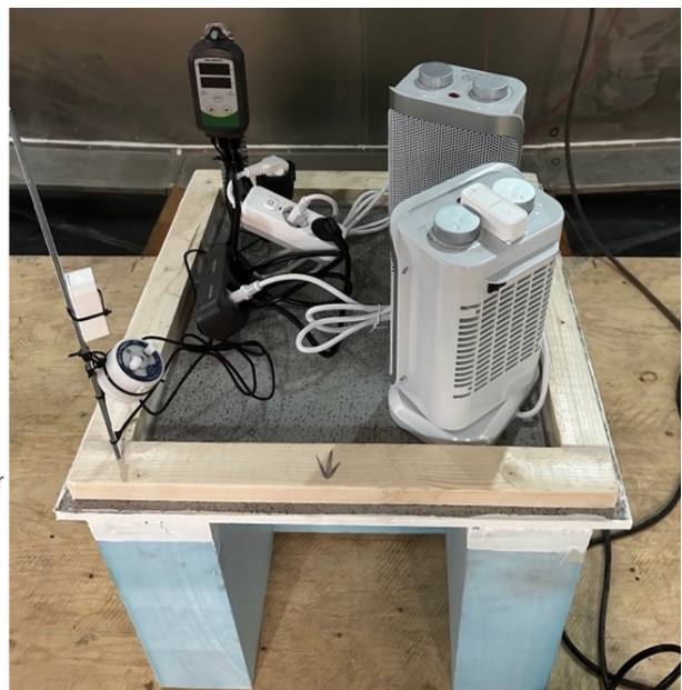
Bild 3.8: Ansicht eines Versuchskörpers mit Beheizungs-, Steuerungs- und Messtechnik
