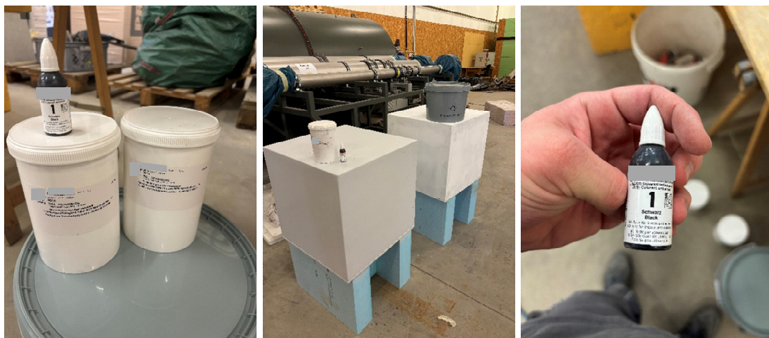
Bild 3.7: Alle drei gebauten Probekörper aus Plattenwerkstoff wurden mit einem Farbeanstrich versehen: ein Probekörper erhielt die BAUTER-Beschichtung, die anderen zwei Probekörper wurden mit einer abgetönten, handelsüblichen Fassadenfarbe ausgeführt. Im mittleren Bild rechts ist der (vordere) dunklere Farbanstrich des Probekörpers mit der abgetönten „neutralen“ Farbe leicht zu erkennen, daneben steht der „BAUTER-Versuchskörper“.
