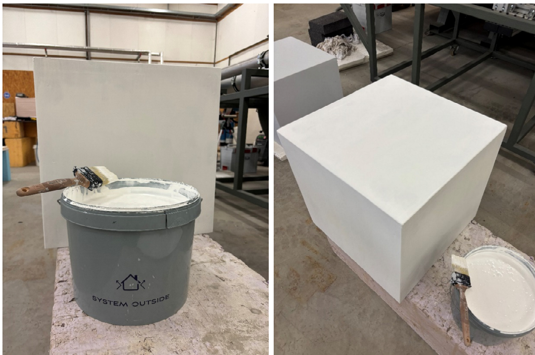
Bild 3.3: Ansicht BAUTER-Versuchskörper: Materialauftrag durch Streichen
