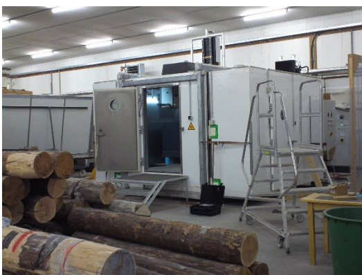
Bild 3.10: Ansicht der Klimakammer in der Versuchshalle des Instituts für Bauphysik. Die drei Versuchsaufbauten wurden simultan und unter gleichen Randbedingungen geprüft.
