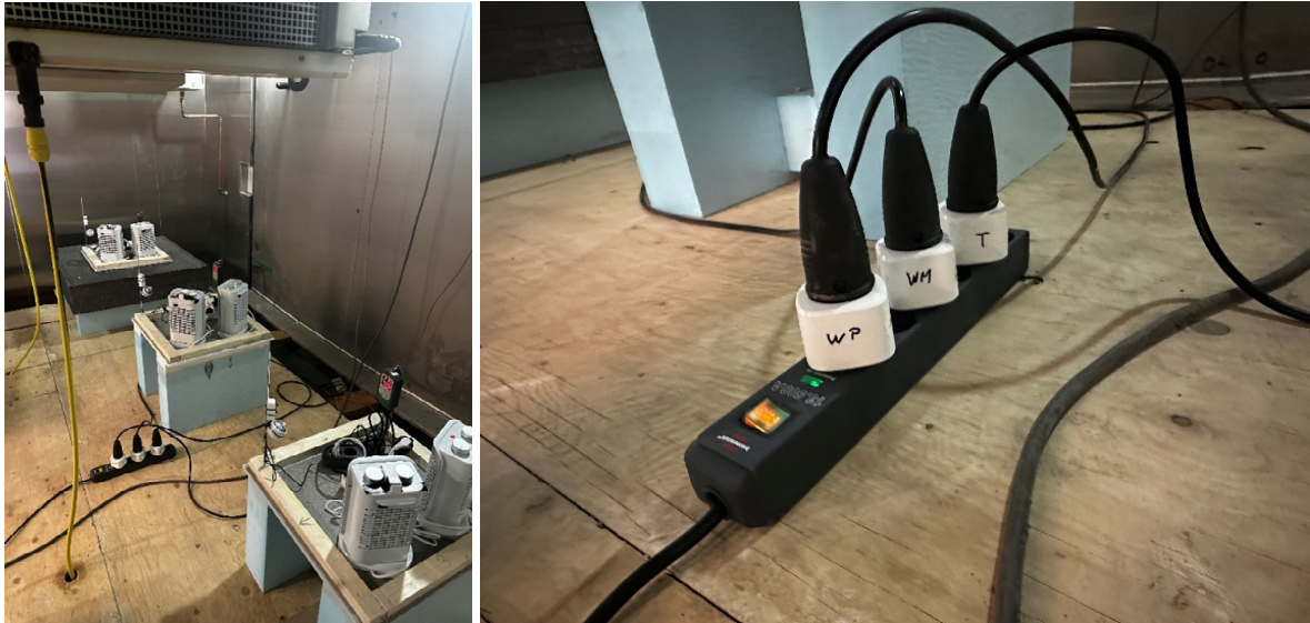
Bild 3.9: Aufbau des Versuches in der Klimakammer, hier noch geöffnete Versuchskörper ohne Hauben, rechts sind im Detail die Stromverbrauchs-Messgeräte (EVE Energy) mit den zu den drei Versuchskörpern führenden Abgängen gezeigt
