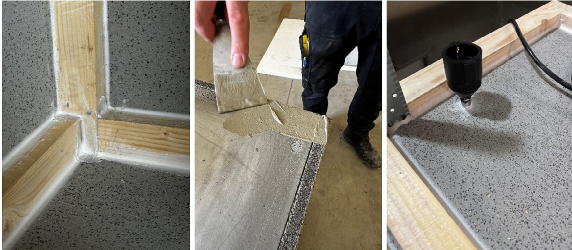
Bild 3.2: Ansicht im Inneren des Probekörper: Versiegelung der Holz-Unterkonstruktion underspachtelung der Außenkanten. Alle Arbeiten erfolgten mit dem Ziel einer hohen Luftdichtheit des Probekörpers.
